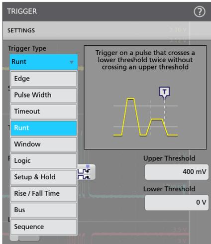
触发菜单中的各种触发类型和上下文相关帮助可以更简便地隔离关心的事件。
