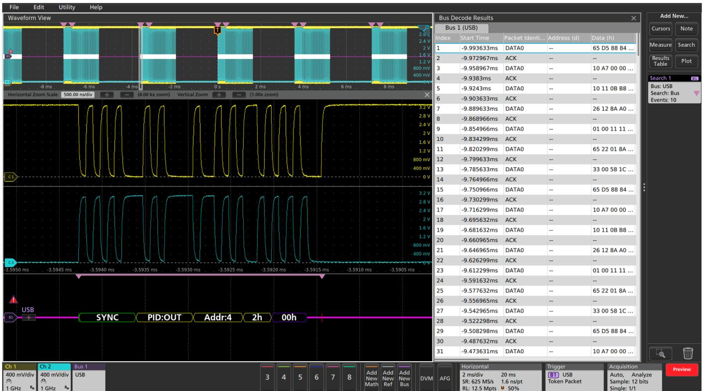
触发 USB 全速串行总线。总线波形提供了时间相关的解码后的包内容，包括开头、同步、PID、地址、端点、CRC、数据值和结尾，总线解码表则显示了整个采集的所有包内容。
