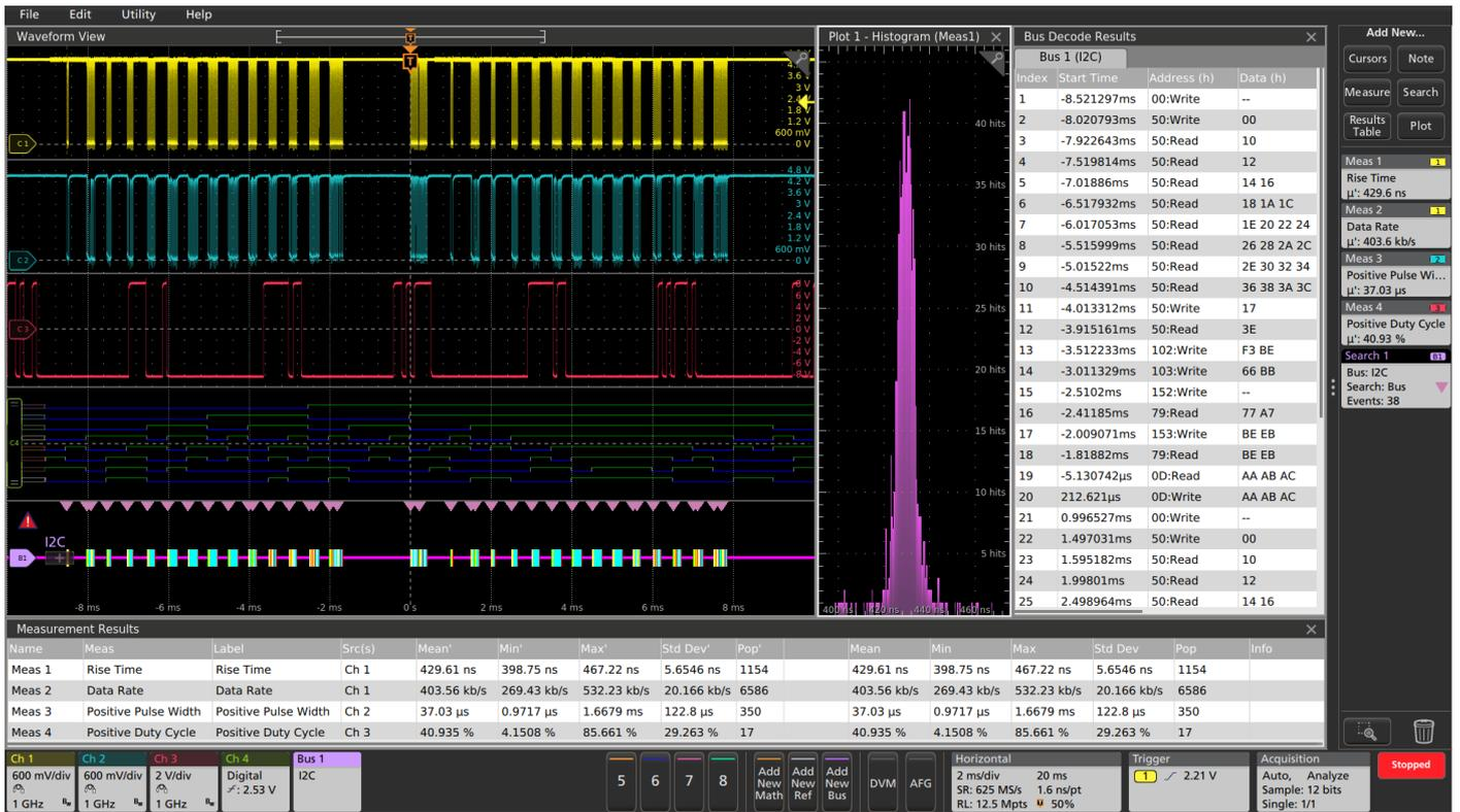
同时查看 3 条模拟通道、8 条数字通道、1 个解码的串行总线波形、解码的串行包结果表、4 个测量、1 个测量直方图、测量结果表和统计数据及搜索串行总线事件！
