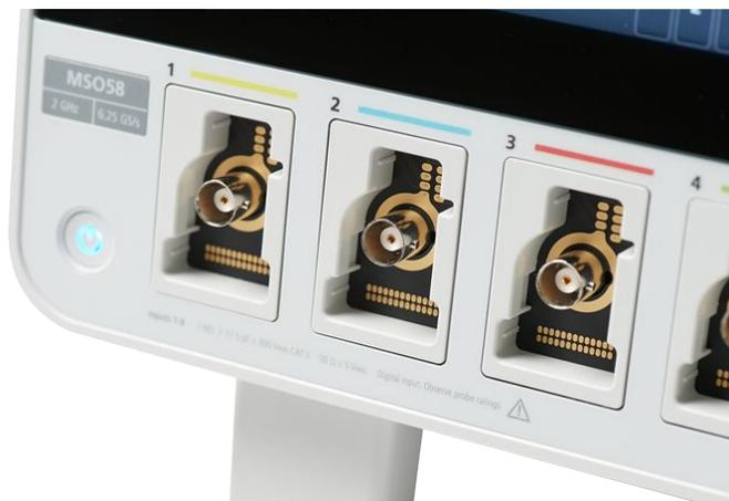
*FlexChannel 技术实现了最大的灵活性。依据连接的探头类型，每个输入可以配置成一条模拟通道或 8 条数字通道。*
