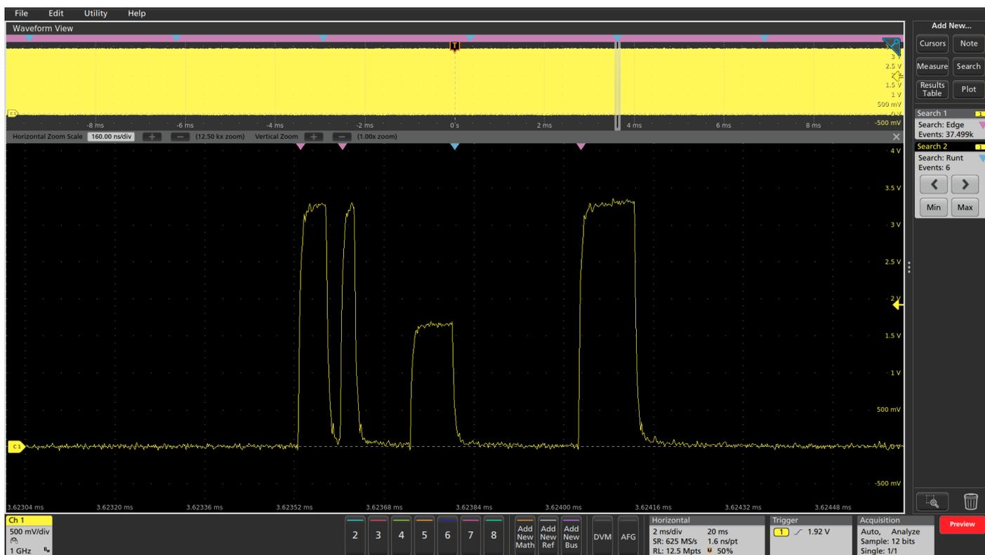
FastAcq 之前发现数字数据流中存在欠幅脉冲, 提示需要进一步调查。这个长 20 ms 的采集中, Search 1 发现采集中大约有 37,500 个上升沿。Search 2 (同时运行) 发现采集中有 6 个欠幅脉冲。
