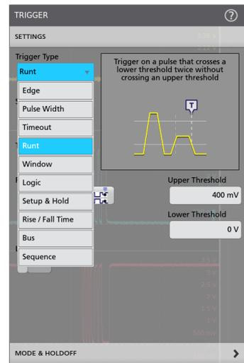
只需触控显示屏上关心的项目两下，就可以进入配置菜单。在这种情况下，触控标志两下，打开触发配置菜单。
