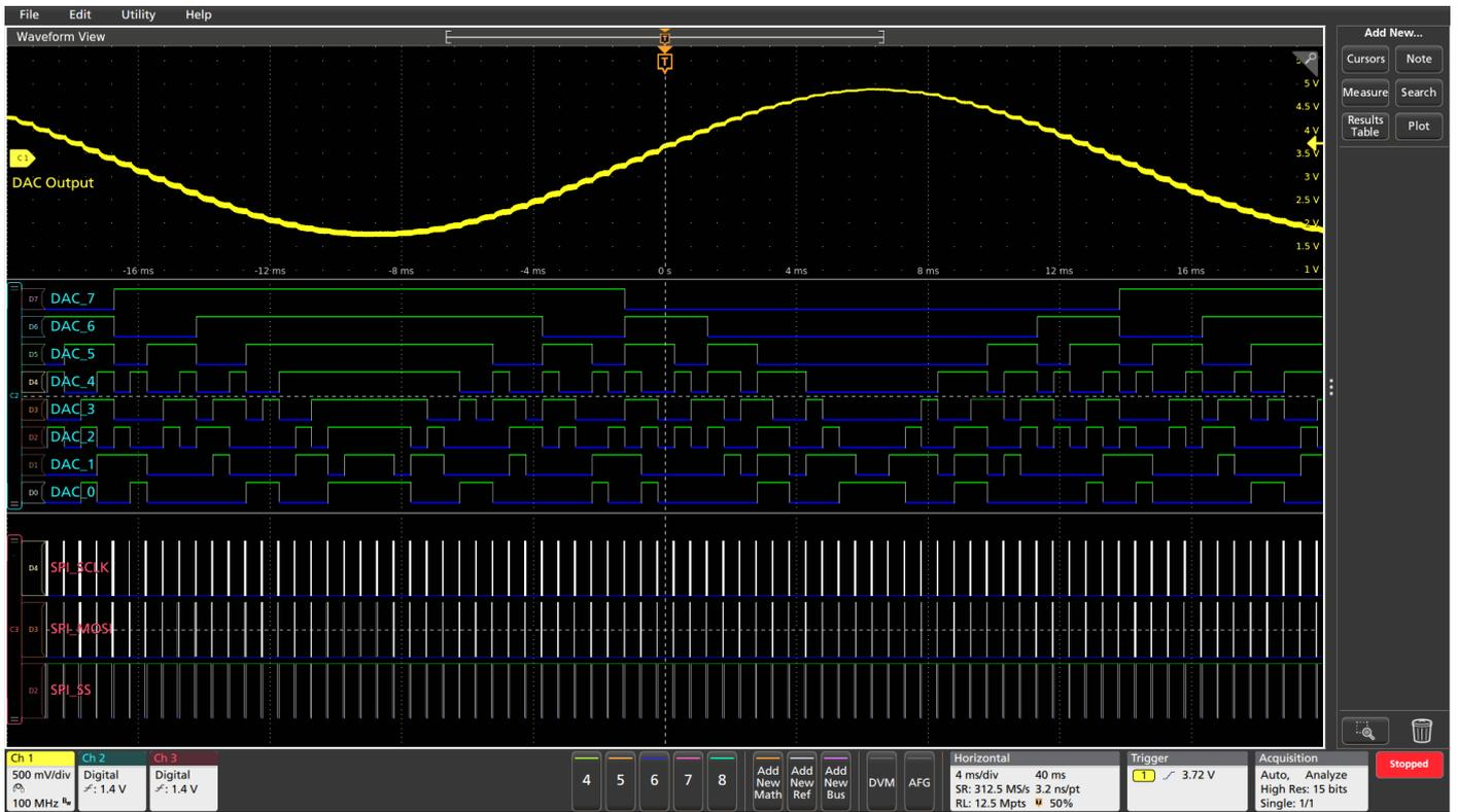
FlexChannel 2 把一只 TLP058 逻辑探头连接到 DAC 的 8 个输入上。注意绿色和蓝色颜色代码，1 为绿色，0 为蓝色。FlexChannel 3 上的另一只 TLP058 逻辑探头探测 SPI 总线，驱动 DAC。白边表示有更高频率的信息可以放大，也可以在下次采集时迁移到更快的扫描速度。
