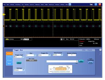
捕获 – 触发经过 RS-232 总线的特定发送数据包。一套完整的触发功能 (包括特定串行数据包内容触发) 保证您可以迅速捕获关心的事件。
