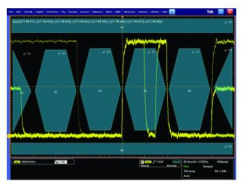
布尔逻辑触发判定。 使用逻辑关系 OR 的布尔逻辑允许用户同时监测每个位,捕获采集中任何点上发生的异常事件。
