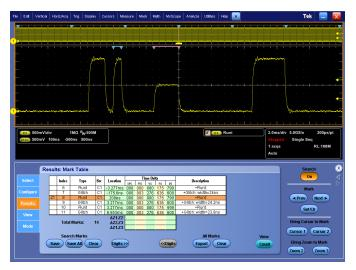
搜索 – 在长波形记录内部查找欠幅脉冲或窄毛刺的高级搜索结果。 欠幅脉冲或毛刺出现的每个时点都被标出,便于参考。
