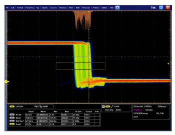
分析 – 下降沿的波形直方图,显示了边沿位置(抖动)随时间变化的分布情况。 其中包括在波形直方图数据上进行的数字测量。 它提供了一套完善的集成分析工具,加快了检验电路性能的速度。
