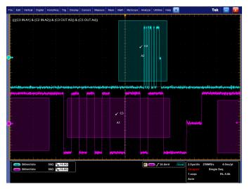
多条通道触发。 可视触发区域可以与跨越多条通道的事件相关, 如两条 USB 2.0 总线上同时传送的数据包。
