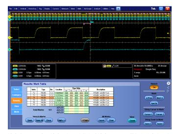
搜索步骤 2: 高级搜索和标记功能自动搜索记录,用带颜色的实心三角号标出每个事件。 然后可以使用 Previous 和 Next 按钮,从一个事件跳到另一个事件。
