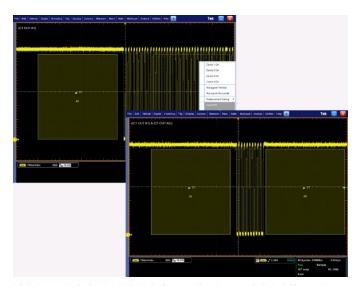
触发由 10 个脉冲组成的突发宽度。通过在第一个时钟脉冲前画一个"必须在外面"的区域,在第 10 个脉冲后面画第二个"必须在外面"的区域,如图所示,您可以定义一个可视触发设置,捕获所需的突发宽度。
