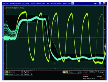
DDR 内存。 可视触发用来隔离 DDR3 特定码型上偶发的写突发。 触发事件是由 11000000 组成的 Write DQ 突发,这时,DQ 发起从非三态电压值开始。 DDR 内存总线事件涉及时钟通道、选通通道和数据通道以及数据的多个幅度和突发。
