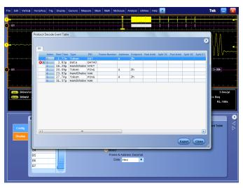
事件表显示了长采集中解码后的串行数据包数据。
